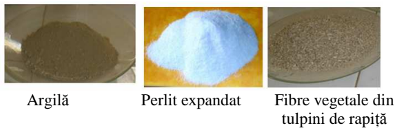
Fig. 1 Materiale folosite la obținerea compozitelor
