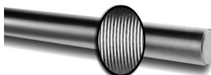
Fig. 6 Presa cu film preformat pentru tratarea la suprafața a hârtiei și bara pentru reglarea grosimii filmului de pastă
